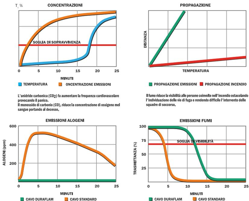
Gli alogeni riducono la percezione delle persone diminuendo la reattività muscolare; sono molto corrosivi e possono causare danni irreversibili all'apparato respiratorio. Dato l'elevato grado di corrosione, sono molto aggressivi verso apparati elettrici, elettronici, arredamenti, etc.
