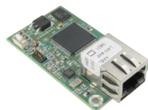
Il modulo di rete AX-LAN permette di interfacciare la centrale Axò 404 con la rete Ethernet e con il suo web server installato a bordo scheda consente l'interazione e la gestione locale e remota di tutte le funzioni dell'impianto anche sfruttando App e portale Axel-Cloud\*.
